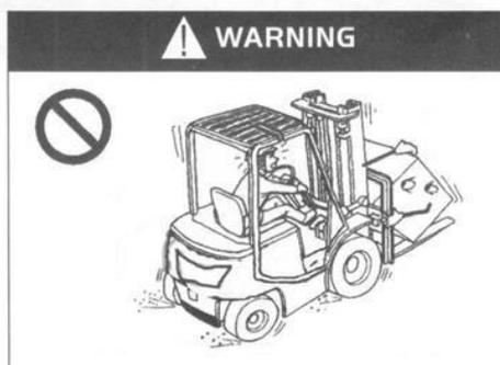
Mova-se calmamente para evitar aceleração e desaceleração repentinas.
