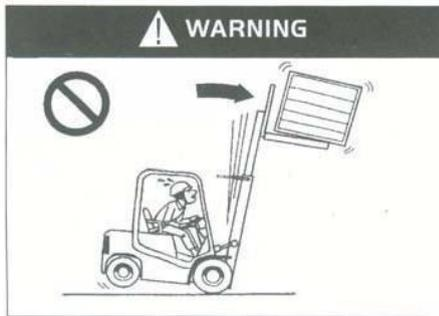
Proibida inclinar o mastro para frente com carga e garfos altos, de modo a evitar o tombamento!
