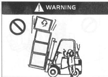
Não carregue cargas a uma altura maior do que a do apoio de carga!
