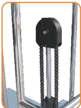
Torre composta por barras tubulares reforçadas proporcionam segurança e estabilidade. A roldana no topo do pistão é protegida por uma capa metálica para evitar acidentes com a corrente.
