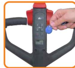
Cabeça de comando ergonômica com PIN code, RFID e operação mesmo com a alavanca de comando na posição vertical (velocidade reduzida) facilita a locomoção em áreas restritas, tais como elevadores e plataformas sem comprometer a segurança.
