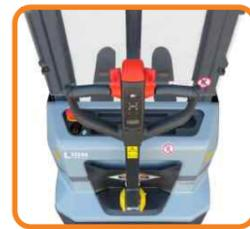
Mastro longo assegura maior estabilidade e aumenta o campo de visão do operador, carenagem de aço tem durabilidade superior a modelos similares de plástico.
