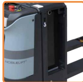
Compartimento da bateria com tampa feita em aço e com saída lateral sobre roletes. A carenagem inferior possui 8mm de espessura e protege os componentes eletrônicos de eventuais batidas. Os garfos são feitos com perfis de 18mm de espessura para evitar torções comuns em outras marcas.
