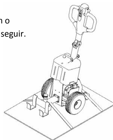
Fig. 5: Pontos de fixação
