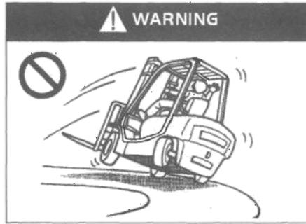
Não é permitido realizar curvas em alta velocidade, estando o equipamento carregado ou não
