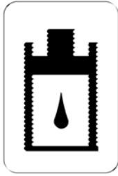
Aviso de adicionar óleo hidráulico
