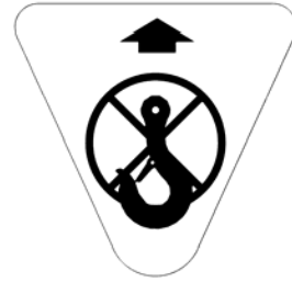
Aviso de proibido içamento
