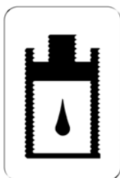
Aviso de adicionar óleo hidráulico
